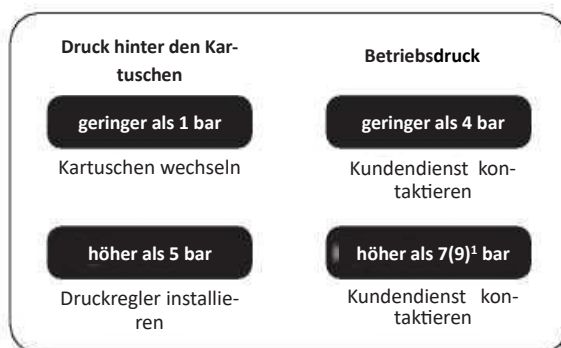
Abbildung 7. Betriebsparameter der Anlage
